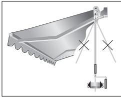
Drehrichtung der Handkurbel beim Ausfahren: Rechts (Uhrzeigersinn).
