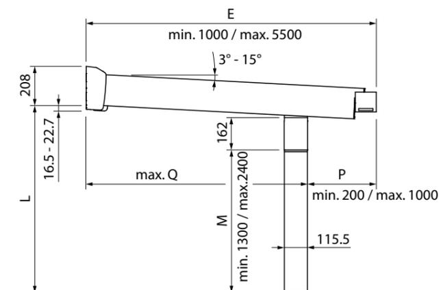
E = Sporgenza orizzontale (min. 1000mm / max. in base a carico del tetto)
