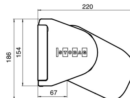
FISSAGGIO A SOFFITTO, INCLINAZIONE A 5°
