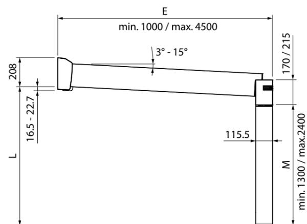
E = Sporgenza orizzontale (min. 1000mm / max. in base a carico del tetto)
